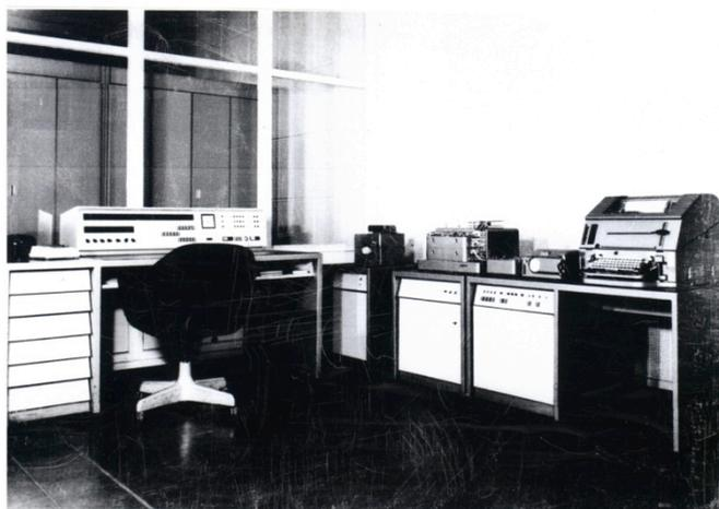
**Figura 2.** El computador Standard Elektrik Lorenz ER-56 (Foto gentileza de W. Riesenköning).
